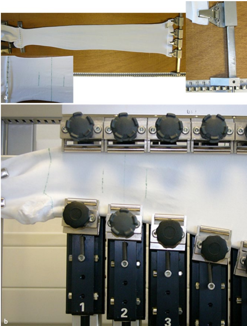
Abb. 2 a Strumpf mit Markierungen auf dem Maßtisch. b Hartmann – Cambren® C im HOSY-Prüfstand. Die Markierung „B“ liegt mittig in der 100%, Klemme 2
